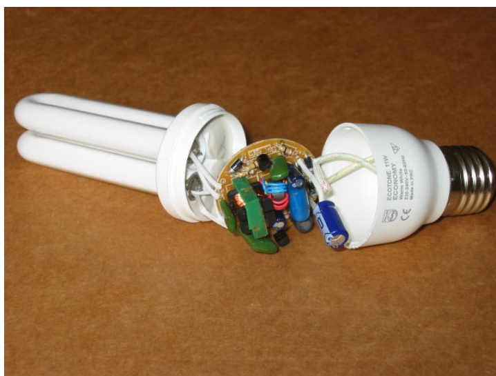
Lampe fluocompacte Philips démontée : tube, ballast électronique et culot
